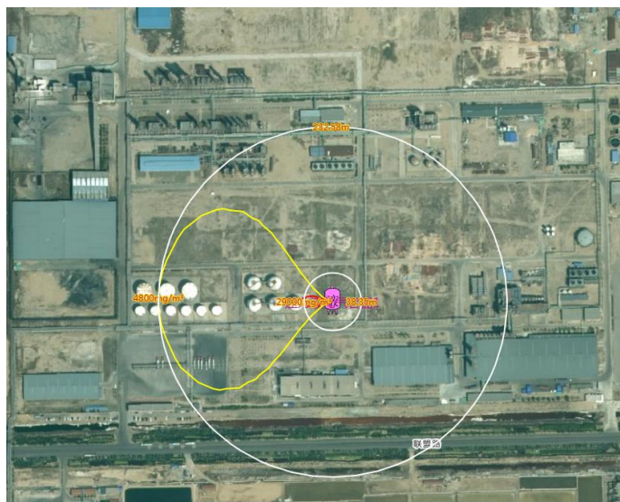
图 5.9-5 最不利气象条件下丙烯达到各阈值的最大影响区域范围图
